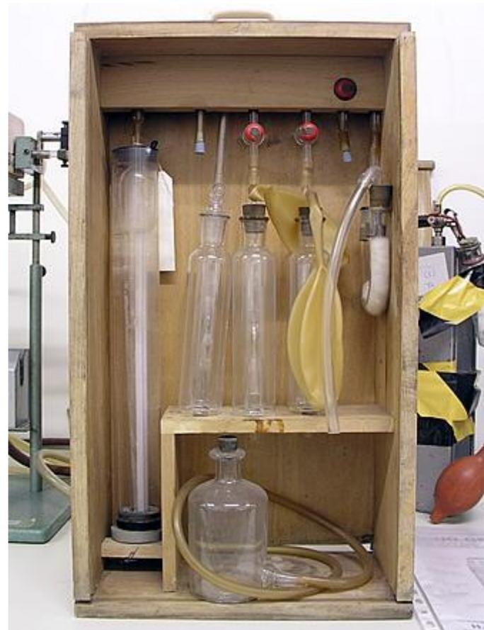
**Orsat-Gerät zur manuellen Rauchgasanalyse**
