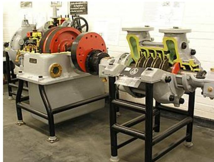
**Kesselspeisepumpe mit Getriebe**
